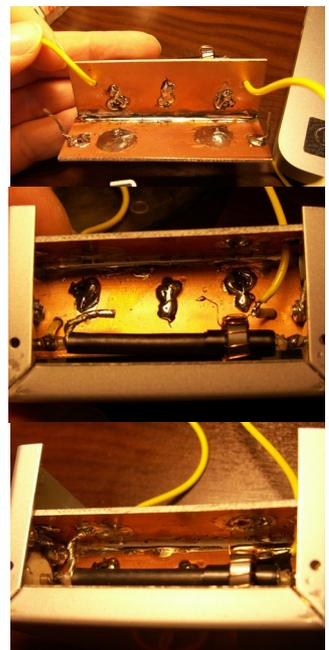
Vom Stromkoppler werden sowohl das nach lose Kupferlackdraht-Ende wie auch die RG58-Abschirmung am Abschirmgehäuse angelötet.
